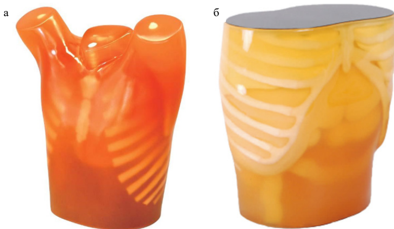
Рисунок 2. а — КТ-фантом «LUNGMAN», представляет собой анатомически точную модель мужского торса в натуральную величину; б — КТ-фантом органов брюшной полости
